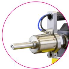
Die Matrizenüberwachung **TOX®-ToolCheck** überwacht pneumatisch den Zustand der TOX®-Cinch-Matrizen. Sie wird entweder in die Zange integriert oder stationär, in Reichweite des Roboters installiert. Fehlende oder z.B. durch Verschmutzung verklemmte Lamellen sowie Ausbrüche an der festen Matrize oder von Festanteilen werden in weniger als einer Sekunde erkannt.
