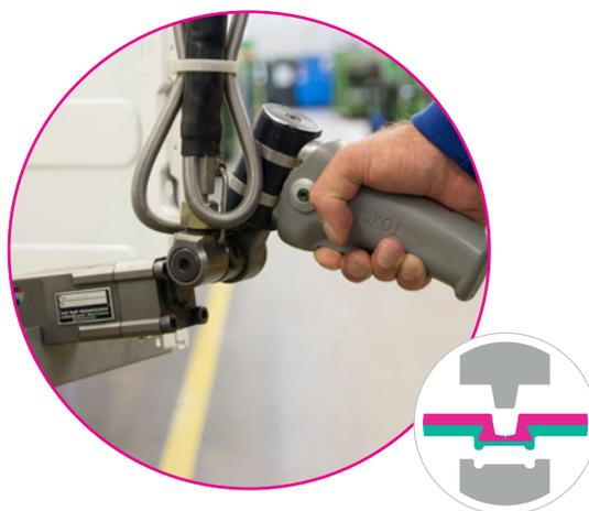
Flanschzange mit TOX®-Mini-Hydraulikzylinder
