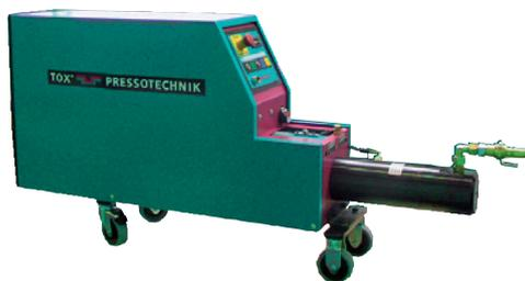
Der externe **TOX®-Druckübersetzer** übersetzt den angeschlossenen Luftdruck von 6 bar in den benötigten Öldruck von 250 oder 470 bar. Je nach Applikation wird der Übersetzer stationär, waagrecht in einem Wagen oder senkrecht an einem Ständer montiert.
